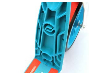
wytrzymała rama z polipropylenu
